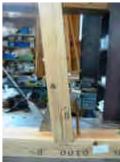
写真 4.3.3 右下接合部（最大変形時）
