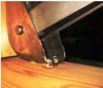
写真 4.5.5 金物ビスの抜け（最大変形時）
